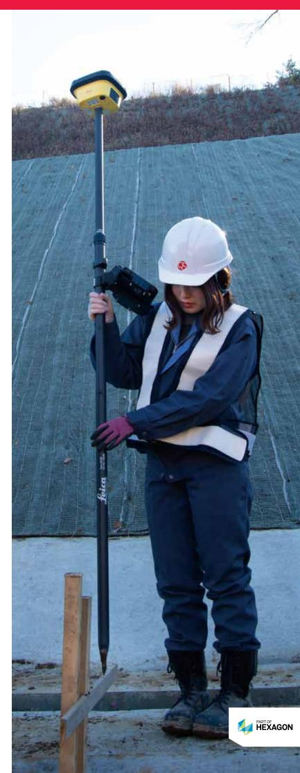
丁張マイスターは、Android OSのPanasonicタフパッドで動く、丁張作業専用ソフトウェアです。Leica Geosystemsの最 新鋭GNSS受信機、iCON gps 70Tとケーブルレスで接続して使用します。
