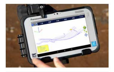
xmlデータはもちろん、3Dポリラインデータでも作業が可能です。道路セ ンタ-以外にも指定したラインを基準に出来ます。複合線形があるインタ ーチェンジや盛土の巻込み部、そして線形を基準にしない造成工事など1 つのデータで一元管理を行うことができます。
