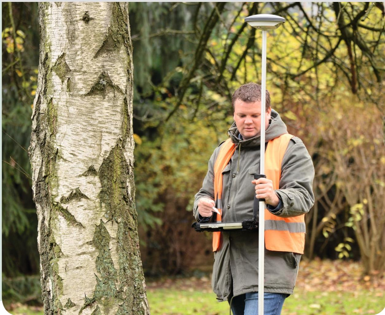
le Toughpad FZ-G1 de Panasonic équipé de l'antenne intelligente Zeno GG03 GNSS et le CS25 GNSS plus avec l'antenne Helix de Leica Geosystems.
