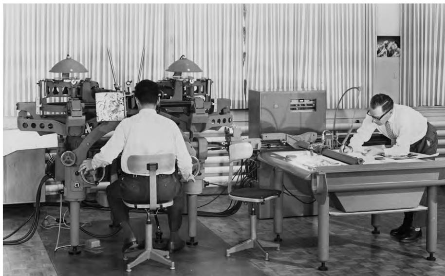
Abb. 10: Der Autograph A8 mit Zeichentisch und elektrischem Koordinaten-Registriergerät Wild EK3.
