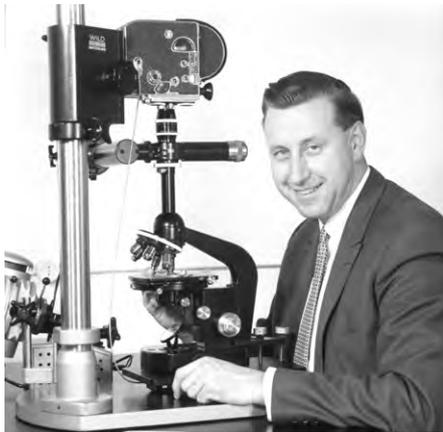
Abb. 7: Hans A. Traber am Forschungsmikroskop mit angebauter Filmkamera.
