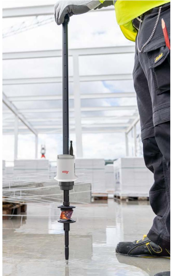
**Abbildung 3:** Stecken Sie Punkte mit höchster Genauigkeit im umgekehrten Neigungsmodus ab, indem Sie eine geringe Zielhöhe verwenden.
