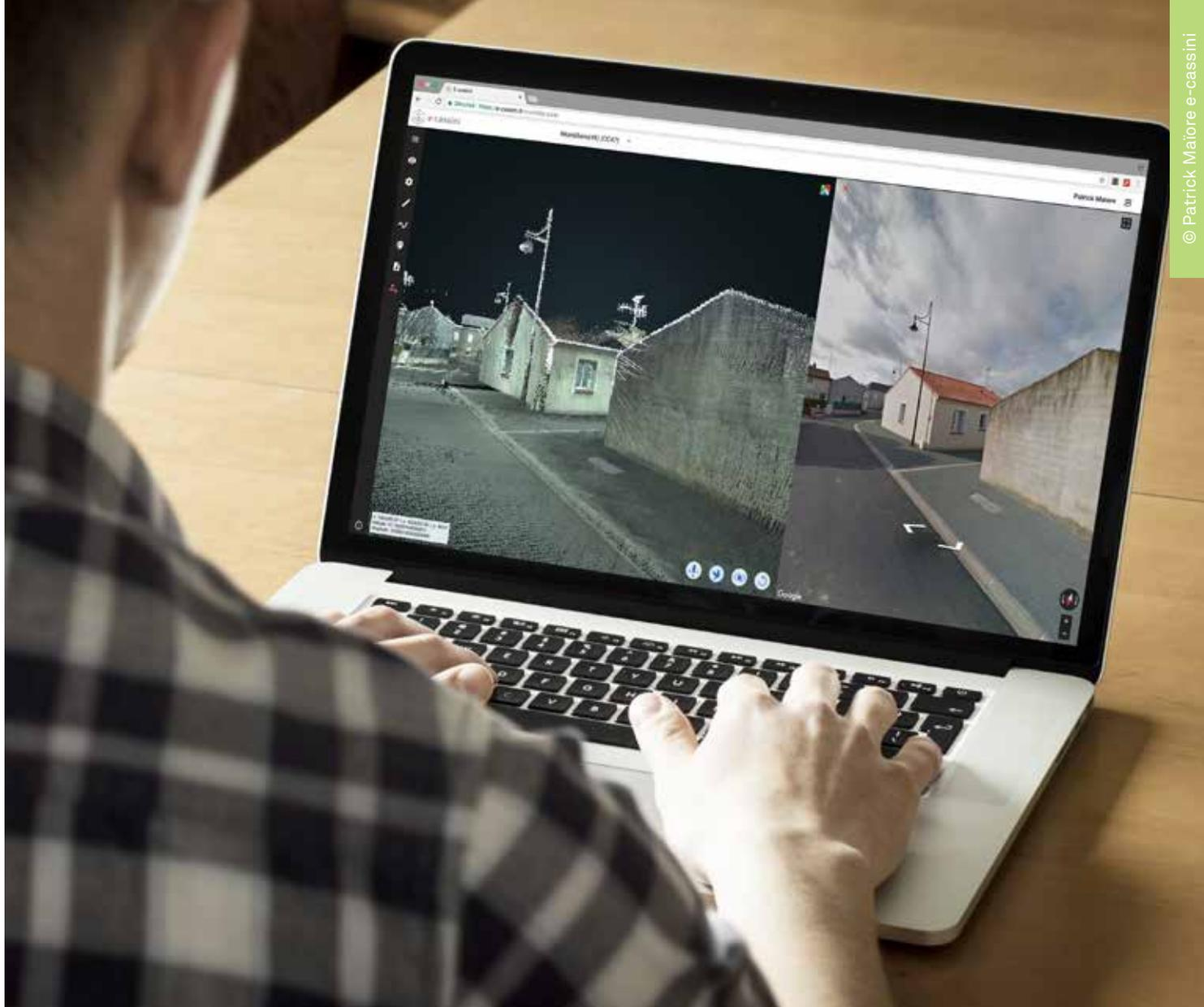
der Genauigkeit der Bewegungsbahn wird die Datenerfassung durch Passpunkte ergänzt. Die Anzahl der Passpunkte richtet sich nach der benötigten Genauigkeit. e-Cassini hat eine Methode zur Erzielung einer Absolutgenauigkeit von  $\pm 4$  Zentimetern in x, y, z entwickelt.
