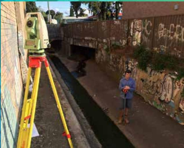
**Vermessung eines Entwässerungskanals, Australien**
