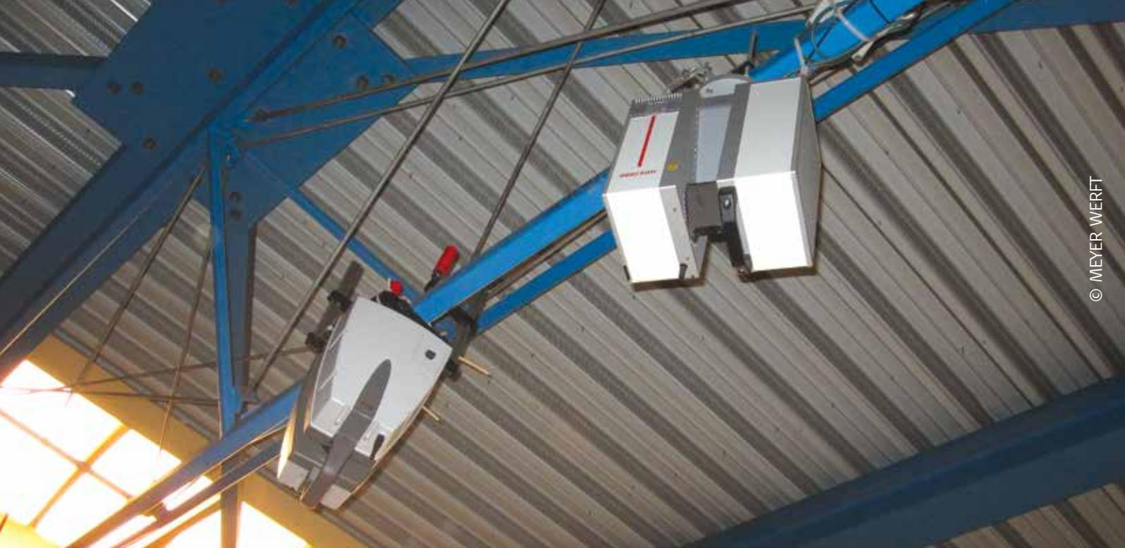
Abweichungen sofort bei ihrem Auftreten und vor der Montage der vorgefertigten Elemente zu entdecken. Mit Hilfe der 3D-Laserscanning-Technologie ist es uns außerdem gelungen, noch anspruchsvollere Standardisierungsanforderungen, wie Strukturanalysen, Reverse Engineering und Volumenberechnungen, während des Bauvorgangs zu erfüllen. Neben der Vermessung zur Bauüberwachung dienen die Daten auch als Dokumentation für etwaige Garantiefälle.
