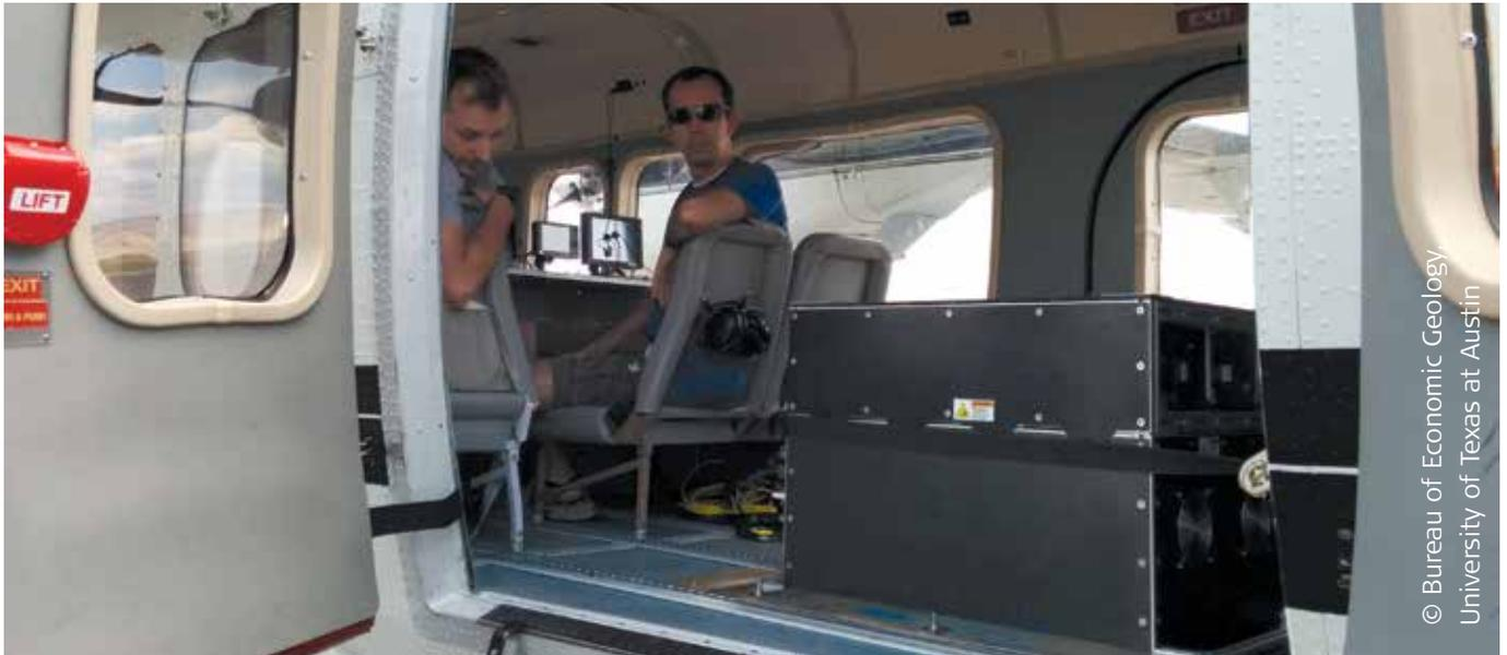
Fehler können durch die Auswertung angrenzender und gegenüberliegender LiDAR-Messstreifen erkannt werden“, so Hupp. „Nach der Rekalibrierung sollten sich die bei verschiedenen Überflügen erfassten LiDAR-Punkte theoretisch auf durchgängigen Oberflächen völlig überlappen. Obwohl wir das gar nicht erwartet hatten, wurden in der Praxis sehr gute Ergebnisse erzielt.“
