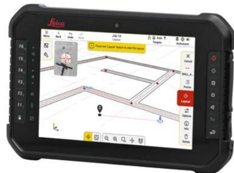
Die Software Leica iCON trades für Aufmaß und Absteckung ist speziell auf die Anforderungen von Polierern, Bauvermessern, Sanitärinstallateuren und Trockenbauern ausgelegt. Sie entspricht branchenspezifischen Arbeitsabläufen, unterstützt alle anfallenden Absteck- und Markierungsaufgaben und ist dabei sowohl für einfache als auch komplexe Projekte ideal geeignet. Die Anwendung ist unkompliziert, sodass Gerät und Software sofort eingesetzt werden können.
