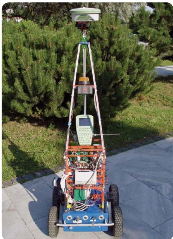
■ El robot exterior con Leica GPS1200.
