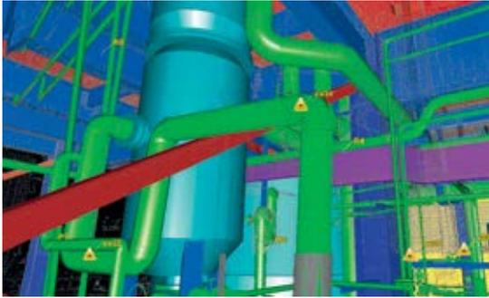
La función automática Pipe Run permite al usuario seleccionar puntos de secciones conectadas, tubos rectos y el sistema modela automáticamente la mejor tubería codos incluidos en cuestión de segundos.
