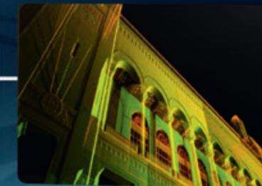
Rilievo accurato della geometria e dettagliato dei siti del patrimonio, non invasivo, per progetti di restauro o di archiviazione. L'ampio campo visivo e il campo di misura ampliato assicura un minor numero di stazionamenti per completare l'operazione.
