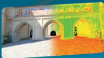
La fotocamera ad alta risoluzione con esposizione automatica fornisce "immagini fotorealistiche" che possono essere applicate sulla nuvola di punti per esaltarne l'interpretazione ed il dettaglio.
