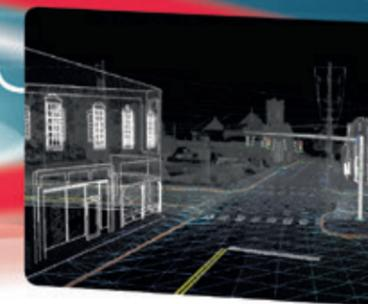
Una vasta gamma dei flussi di lavoro di facile utilizzo per il rilevatore, in modo rapido e sicuro è possibile misurare gallerie, strade, ponti, linee elettriche e più. Con i dati di scansione ad alta definizione, è possibile eliminare la necessità di ritornare sul sito, garantendo mappe topografiche accurate, sondaggi as-built e indagini di rilevamento.
