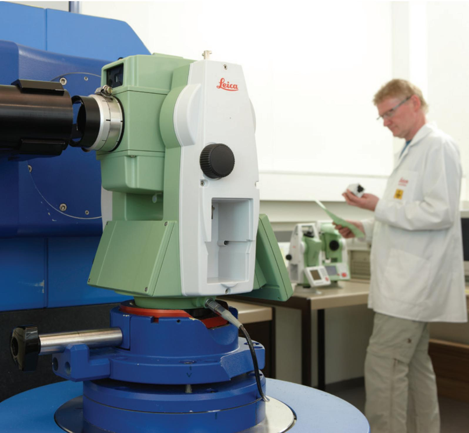
La richiesta complessiva di certificati di taratura a conferma della qualità delle misurazioni ottenute con le apparecchiature di rilevamento topografico, nuove o usate, è in aumento. Questo è dovuto prevalentemente al fatto che sempre più aziende attive nel settore della topografia (e i loro subappaltatori) stanno acquisendo la certificazione ISO 9001, quindi hanno l'esigenza di confermare periodicamente la precisione delle apparecchiature utilizzate.
