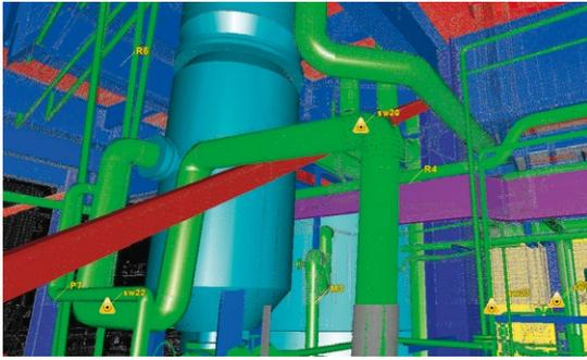
La fonction « ligne de tuyauterie » automatique permet de choisir des points sur des sections de tuyauteries, connectées et droites. En quelques secondes, le système modélise automatiquement une ligne de tuyauterie avec des coudes ajustés sur le nuage de points.
