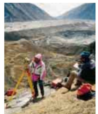
**Mit Leica Theodolit T3000 und Distanzmessgerät DI3000 im Tal des Khumbu-Gletschers (Nepal).**
