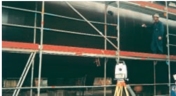
Bild oben: Konventionelle, personalintensive Methode der Rundheitsmessung mit Messbrücke. Bild darunter: Rundheitsmessung mit 3D-Aufnahme durch Leica DCA-TPS Totalstation im Ein-Mann-Betrieb.
