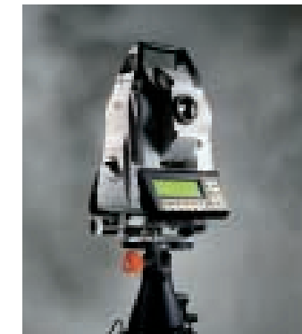
Präzisions-Totalstation Leica TDA5005 mit automatischer Zielerfassung.
