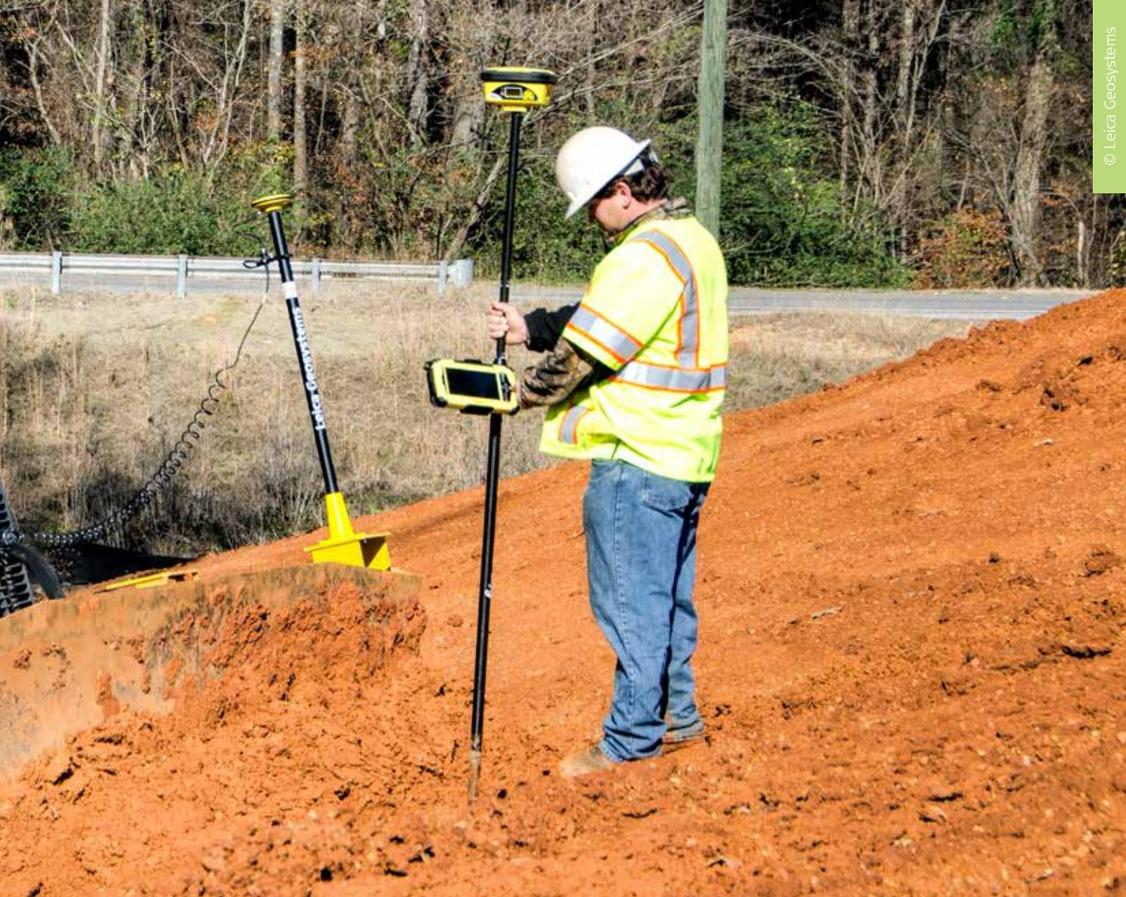
Lizenz für mehrere Rover und Maschinen mit denen am selben Projekt gearbeitet wird. Bei solchen Baustellenlizenzen wird eng mit dem Bauunternehmen zusammengearbeitet, um das Netzwerk zu verdichten, damit die für die Maschinensteuerung erforderliche Genauigkeit erzielt wird. Weil weder eine Basisstation noch Signalverstärker angeschafft werden müssen, rechnet sich die Nutzung des Netzwerkdiensts schnell. Je größer das Bauvorhaben, desto größer der Effizienzgewinn.
