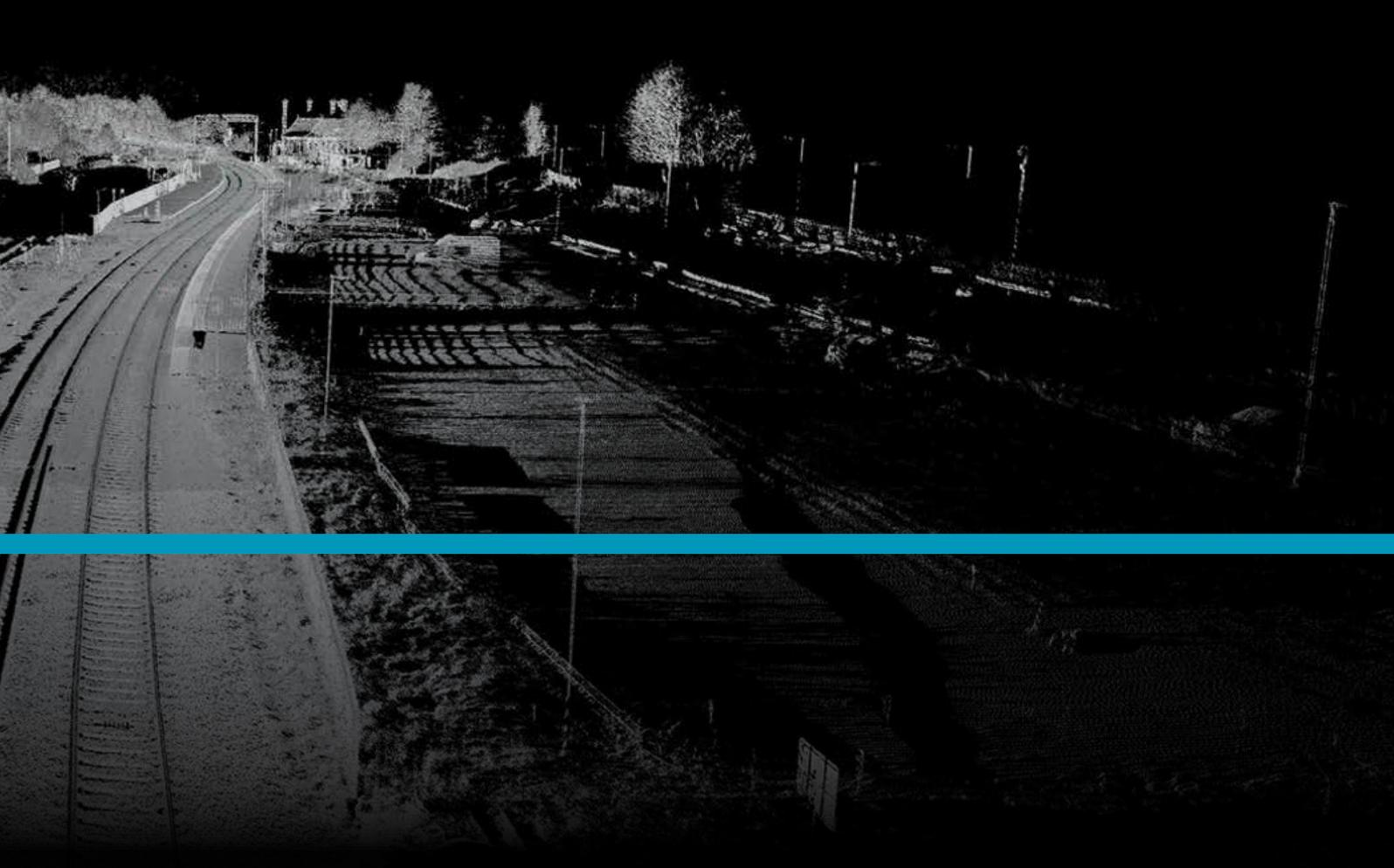
Zur Wahrung höchster Genauigkeit wurde die Punktwolke anhand der neu verfügbaren Spurweitenmessung mit dem Vermessungsnetz des Geländes verknüpft. Die gescannten Gleise wurden automatisch mit den auf herkömmliche Art vermessenen Schienensträngen abgeglichen. Dadurch ergab sich eine Genauigkeit von unter zehn Millimetern relativ zur Spurweite.
