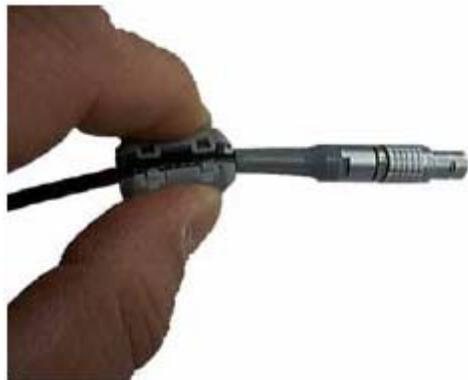
装配铁氧芯时，先打开然后夹住电缆线，扣上。扣在连向全站仪电缆接口约 2cm 处。
