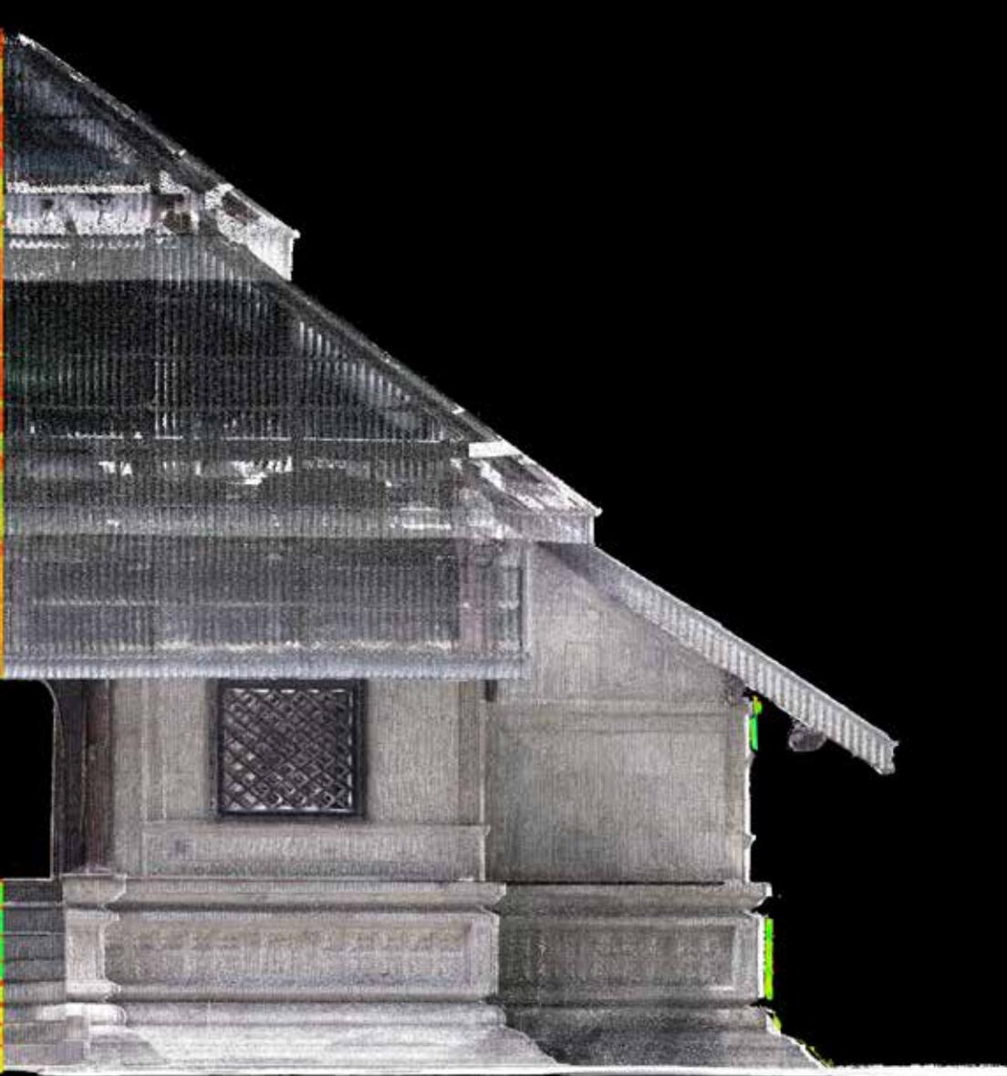
pour établir des points de contrôle sur le site. Pour finir, les spécialistes ont transféré les nuages de points 3D, réalisés sur 360° avec le scanner laser, au logiciel d'assemblage Cyclone REGISTER en vue du post-traitement.
