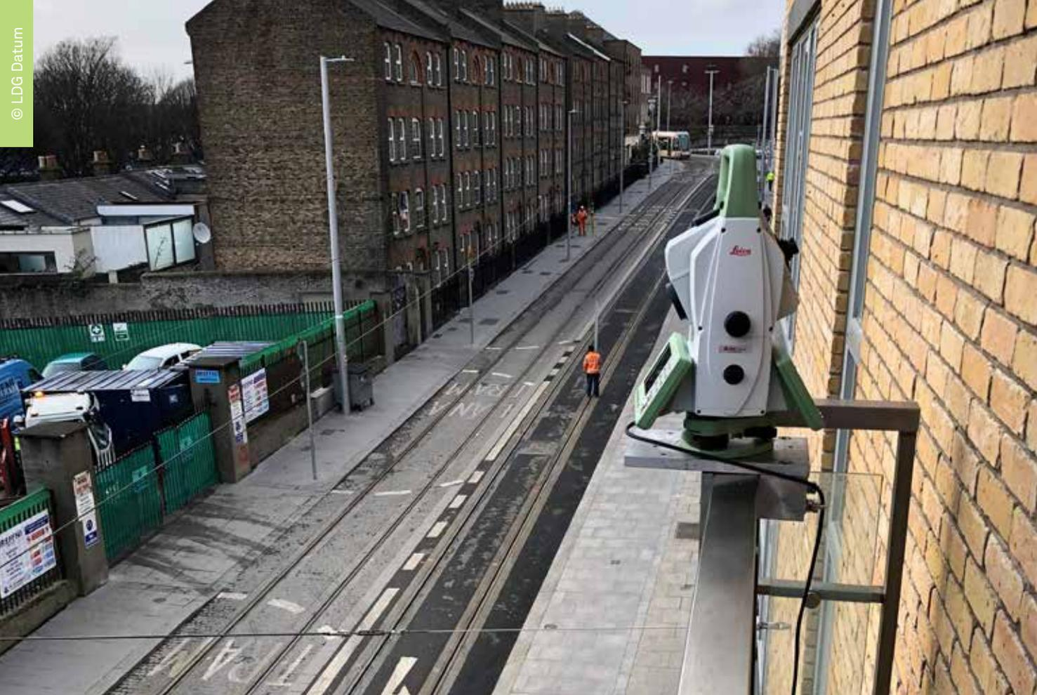
« L'activité locale clé de Datum était de fournir un scanning continu des doubles voies ferrées secondaires du système Luas, en utilisant la MultiStation automatique Leica Geosystems MS60. Ces instruments ont scanné la double voie de tramway en continu et ont chargé les données directement sur une page Internet sécurisée, où les parties concernées pouvaient les consulter », indique Mark Hodgen, directeur chez LDG Datum.
