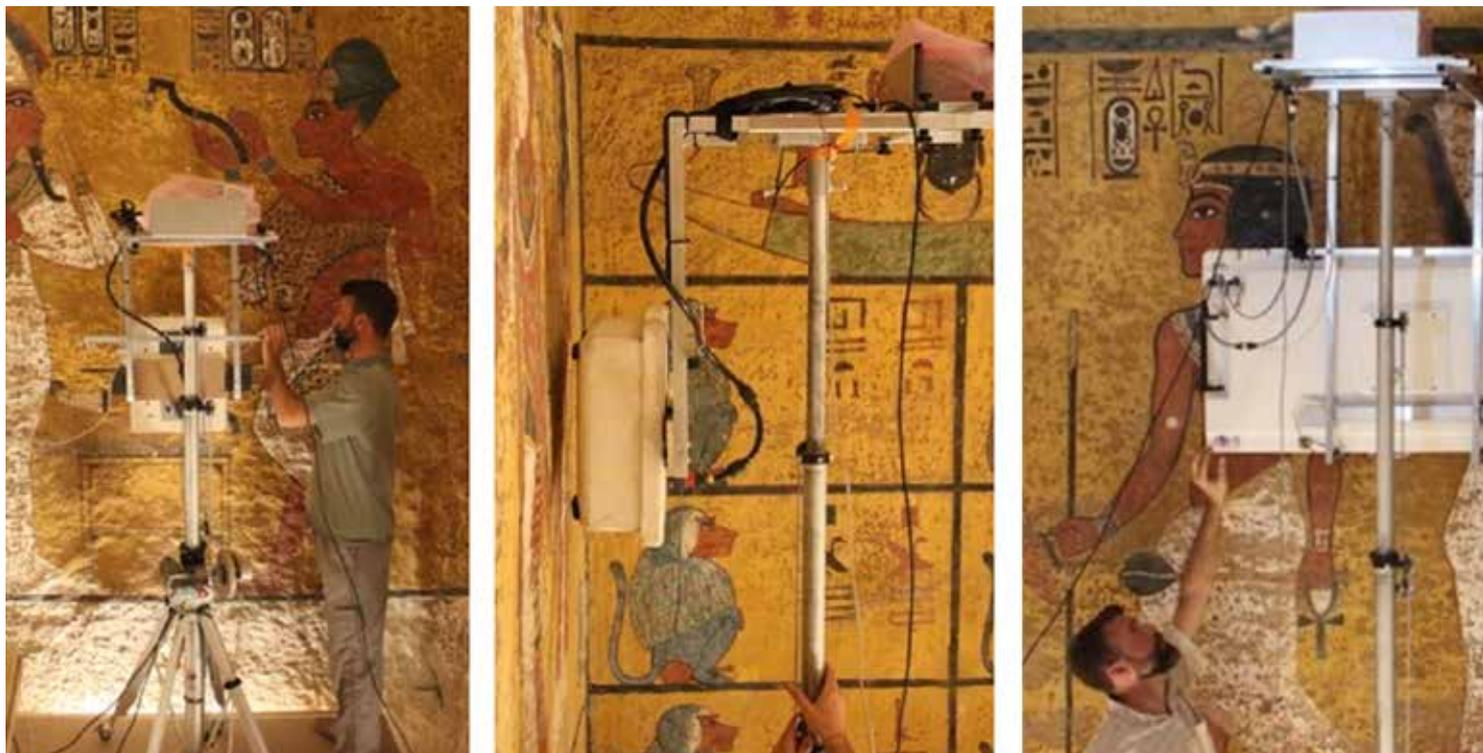
effectuée avec une antenne blindée IDS GeoRadar RIS TR200 opérant en mode transverse électrique (TE) pour collecter des données le long de l'axe vertical, du bas vers le haut. Les spécialistes ont réalisé des scans de fréquence intermédiaire (FI) avec un système IDS GeoRadar Stream C multivoie à double polarisation.
