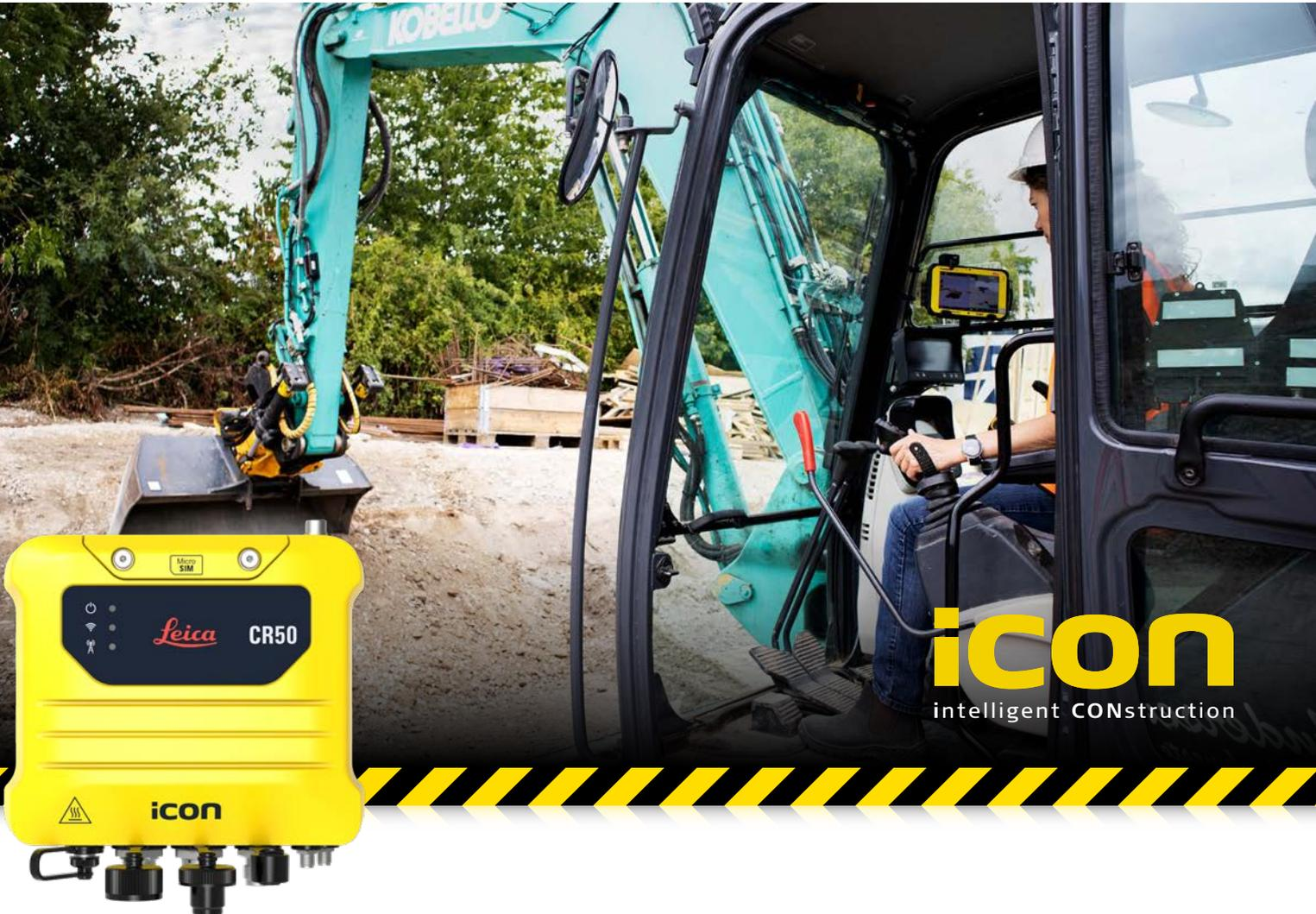
L'unité de communication Leica CR50 prend en charge un modem cellulaire interne et une radio bifréquence. La Leica CR50 peut être connectée au récepteur GNSS sur engin iCON gps 100 pour effectuer un positionnement GNSS RTK de haute précision.
