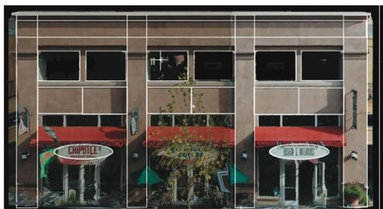
Uno degli usi più comuni delle nuvole di punti in CloudWorx è quello di ricalcare le stesse per creare prospetti 2D e 3D corretti in "wire frames", estrapolare modelli 3D, ecc. Alcuni comandi di CloudWorx semplificano tali operazioni.
