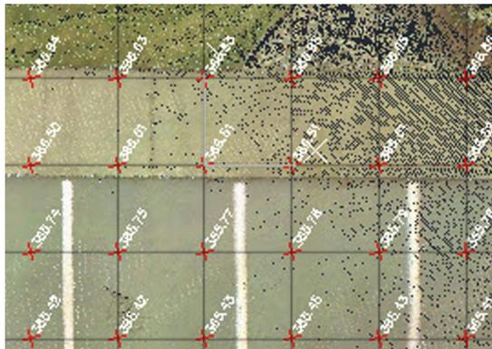
I punti selezionati su una griglia e sistemi di cattura intelligenti SmartPick forniscono uno strumento di monitoraggio automatico altamente produttivo, tipicamente utilizzato per creare punti COGO e generare una superficie \ TIN.
