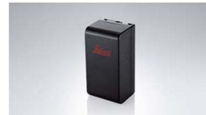
GE121, batteria NiMH Batteria che non richiede manutenzione per strumenti TPS400/800 e DNA, 6,0 V / 4,2 Ah. Articolo: 667123
