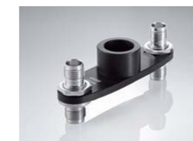
GAD46, doppio braccio per antenne UHF/GSM Adattatore con doppio braccio, si avita all'asta telescopica. Consente di collegare al braccio fino a 2 antenne UHF/GSM e fino a 2 cavi Antenna. Articolo: 734388
