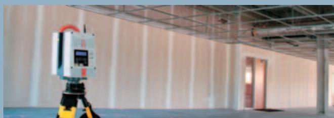
La maggiore portata utile e la migliore qualità dei dati della scansione phase-based garantiscono importanti vantaggi in termini di produttività, ampliando i campi di applicazione fino a comprendere, ad esempio, il rilevamento delle facciate di edifici multipiano.
