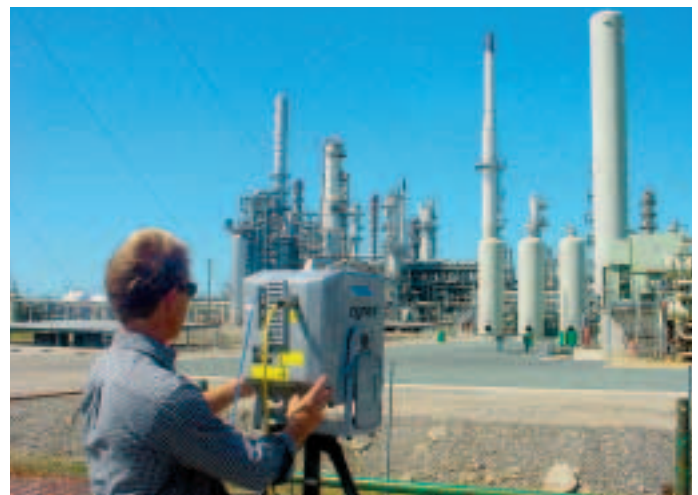
Eines der weiteren Projekte von North Surveys war die Dokumentation der Rohrleitungen der BP-Raffinerie in Queensland mit dem Cyrax 2500.
