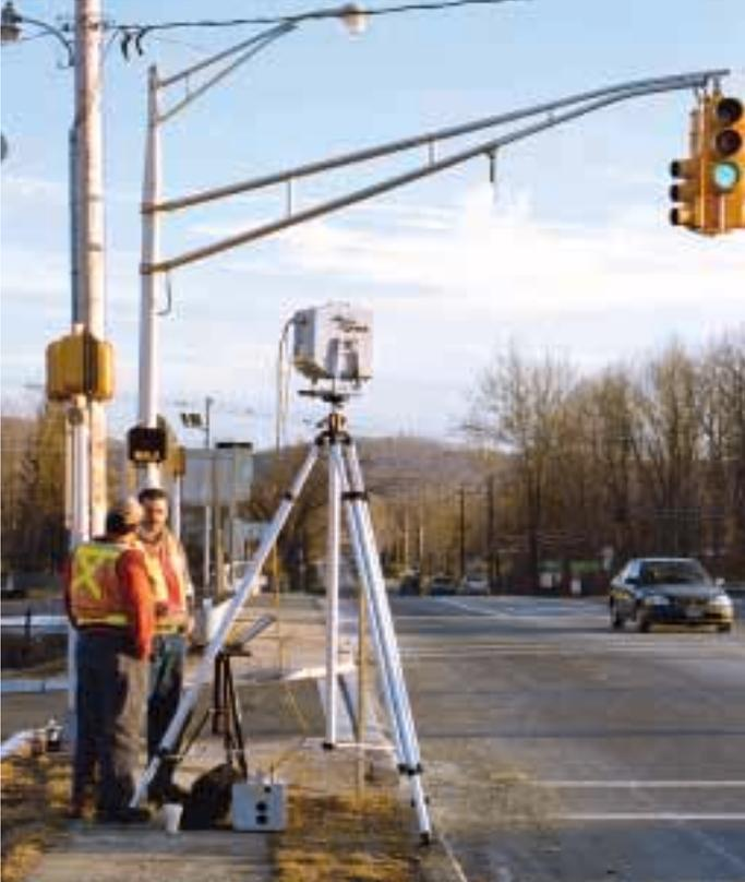
**Vom Strassenrand aus erfasste der Cyrax 2500 Laserscanner detailliert die Strassengeometrie.**
