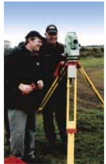
Oben: Ray Copeland erläutert die Leica Roboter-Totalstation mit PowerSearch-Funktionalität.
