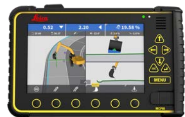
Schermweergave van graafmachine met zwenkgiel
