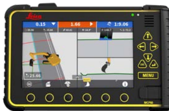
Kjøreskjermer for gravemaskin med svingbar bom
