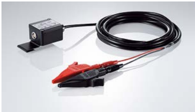
GEV71, Kabel zasilający Kabel o długości 4 m, umożliwia zasilanie instrumentu z akumulatora samochodowego 12 V. Chroni urządzenie przed uszkodzeniem spowodowanym odwróceniem biegunów i skokami napięcia. Nr artykułu: 439038
