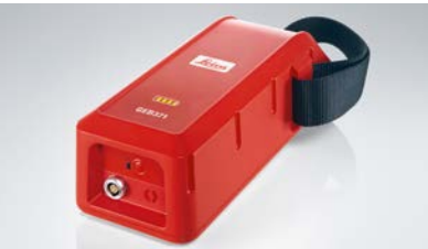
GEB373, Bateria zewnętrzna Li-Ion Bateria o zwiększonej pojemności przeznaczona do długotrwałych pomiarów, 14,4 V / 289 Wh. Wymaga ładowarki GEV242. Wraz z kablem zasilającym GEV277 bateria może zostać użyta jako UPS (nieprzerwana dostawa energii). Waga 2,3 kg. Nr artykułu: 905305
