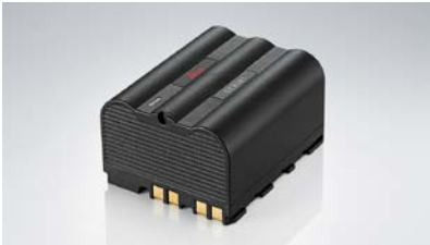
GEB364, Bateria Li-Ion Bateria o dużej wydajności do instrumentów RTC i TS03/07/10 FlexLine; 10,8 V / 6,9 Ah. Nr artykułu: 954519
