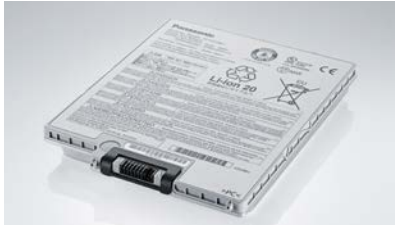
GEB236, Bateria Li-Ion Bateria o zwiększonej pojemności to tabletu CS35; 10,8 V / 8,7 Ah. Nr artykułu: 832120
