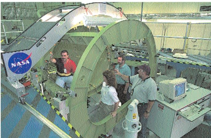
10 à 15 minutes pour le repositionnement et seulement quelques secondes pour la mesure et la saisie de données. «Nous nous promenons avec le LT500 dans toute l'usine», nous explique le directeur de la construction et fabrication du X-38, «et c'est une grande usine. Nous n'avons plus besoin d'amener le composant à mesurer dans la zone de mesure, car nous allons directement mesurer le composant sur son lieu de travail».
