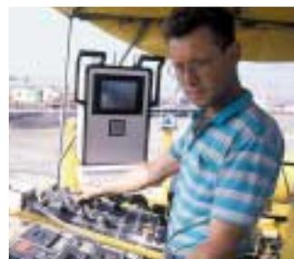
*Dem Maschinenführer Beat Furrer nimmt das Leica Maschinenleitsystem (weißer Kasten) auf dem Führerstand die Steuerung ab: genauso wie ein Flugleitsystem den „Pilotenkollegen“ in den Flugzeugen. Er kann sich ganz auf den Produktionsprozess konzentrieren: „Unsere Rollbahnen sind perfekt!“*
