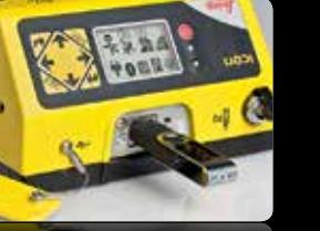
Простое обновление микропрограммного обеспечения и обмен данными с помощью модуля памяти USB.
