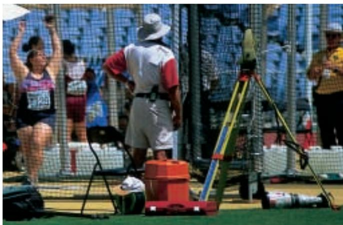
Die Zeit ist die am genauesten definierte und reproduzierbare Größe der modernen Physik. Auch die Weitenmesstechnik, die in Australien zum Einsatz kommt, beruht auf hochpräziser Zeitmessung in Verbindung mit Lasertechnologie.
